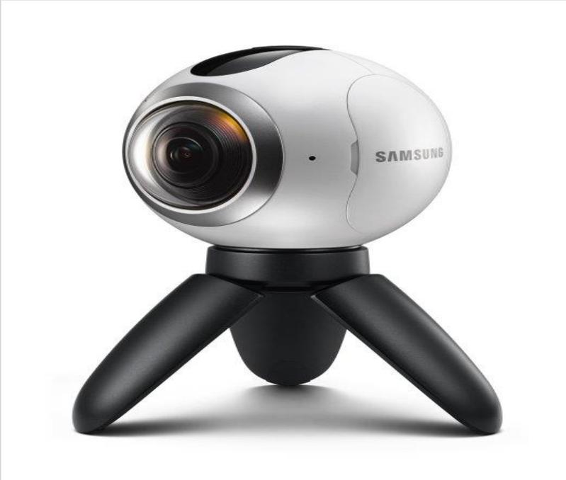
Se compone de dos cámaras de 15MP de gran angular "ojo de pez" con las que capturar una instantánea a 360 grados y a un detalle sorprendente. Cada una de ellas recoge 195 grados. Cuenta con una pequeña pantalla de 0,5 pulgadas, ranura micro-SD, WIFI, Bluetooth, NFC, resistencia al agua y polvo con indicación IP53. Tiene una batería de 1.350mAh. Todo ello en un dispositivo del tamaño de una pelota de tenis.
