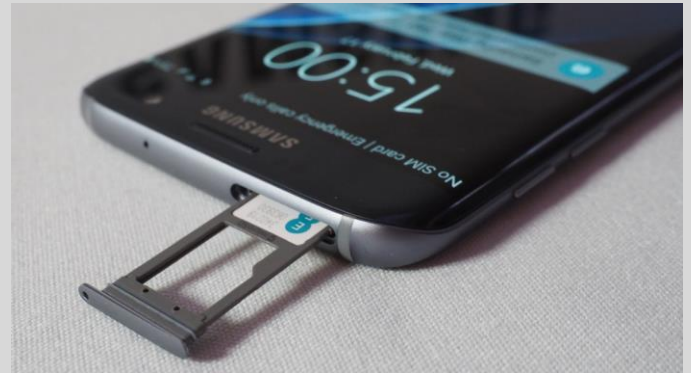
El slot para la microSD compartido con la SIM
